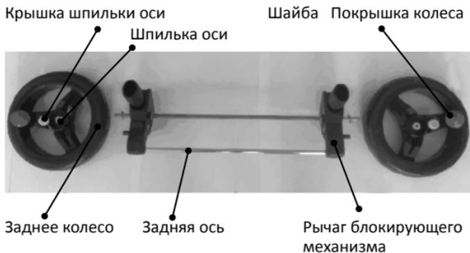
Поверните заднюю ось / крепление заднего колеса, вверх отверстиями и блокирующими рычагами. Разместить каждую шайбу на оси. Все колеса на оси и выступающие части блокиратора направлены внутрь. Протолкнуть шпильку в каждый конец оси, чтобы неподвижно зафиксировать. Закрывать открытые концы оси покрышками колес.
