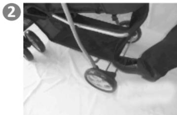
2. Чтобы активировать тормозные устройства, надавите на тормозной стержень. Чтобы ослабить тормозное устройство, поднять стержень вверх.
